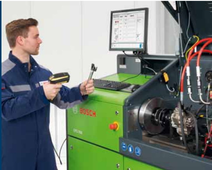
Ihr Diesel-Spezialist verknüpft den gescannten Komponenten-Code mit dem Testergebnis
