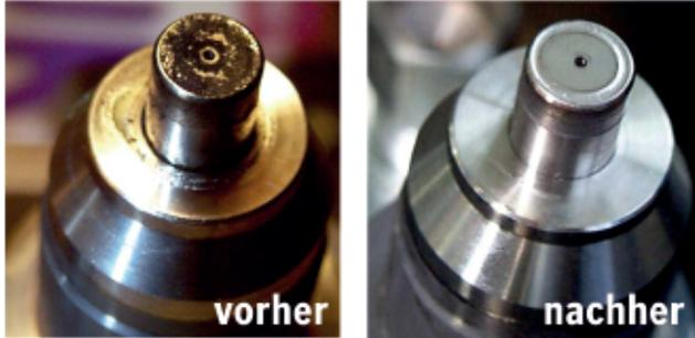
Verbrennungs- und Additivrückstände werden mit dem speziell entwickelten und patentierten Reinigungsprozess per Ultraschall entfernt.
