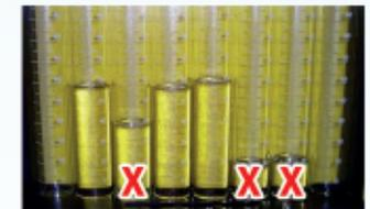
Extrem unterschiedliche Verteilung, Zerstäubung und Einspritzmengen
